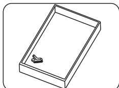
01 对安装表面的杂物进行清洁，确保安装表面清洁干净。
