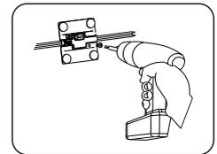
注：打螺丝需在模组斜对角打2颗螺丝固定，单颗螺丝固定容易造成板子倾斜/损坏等风险；
