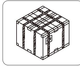
⑥ 外箱上加好护角后,纵向和横向打上打包装带；
