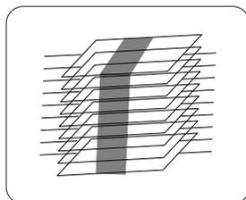
② 将整串模组重叠起来(透镜贴PCB板背面), 然后用PE膜缠紧；
