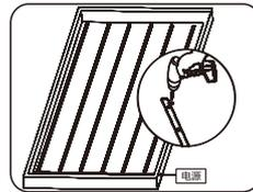
④ 确定安装无误后，打好螺丝固定好产品，同时通电，正常点亮产品，即可。
